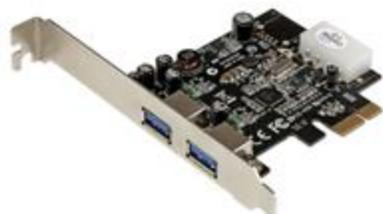
La tarjeta PCI Express USB 3.0 de 2 puertos, modelo PEXUSB3S25, le permite agregar dos puertos USB 3.0 a cualquier sistema con una ranura PCI Express disponible, al tiempo que incluye un conector LP4 opcional de alimentación eléctrica, que ofrece hasta 900 mA de potencia por puerto a los dispositivos con alimentación de bus USB 3.0 (500 mA, en el caso de USB 2.0) que conecte.
