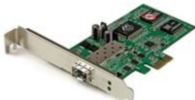
La tarjeta de red PCI Express de Fibra Óptica Gigabit, modelo PEX1000SFP2, permite la conexión directa de un PC basado en PCI Express con una red de fibra óptica mediante un SFP Gigabit SFP de su preferencia.
