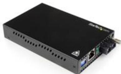
El Convertidor de Medios Gigabit 1000 Mbps a Fibra Monomodo SC (40 km), ET91000SM402 permite extender una red Gigabit Ethernet a través de una fibra monomodo a distancias de hasta 40km (25 millas).
